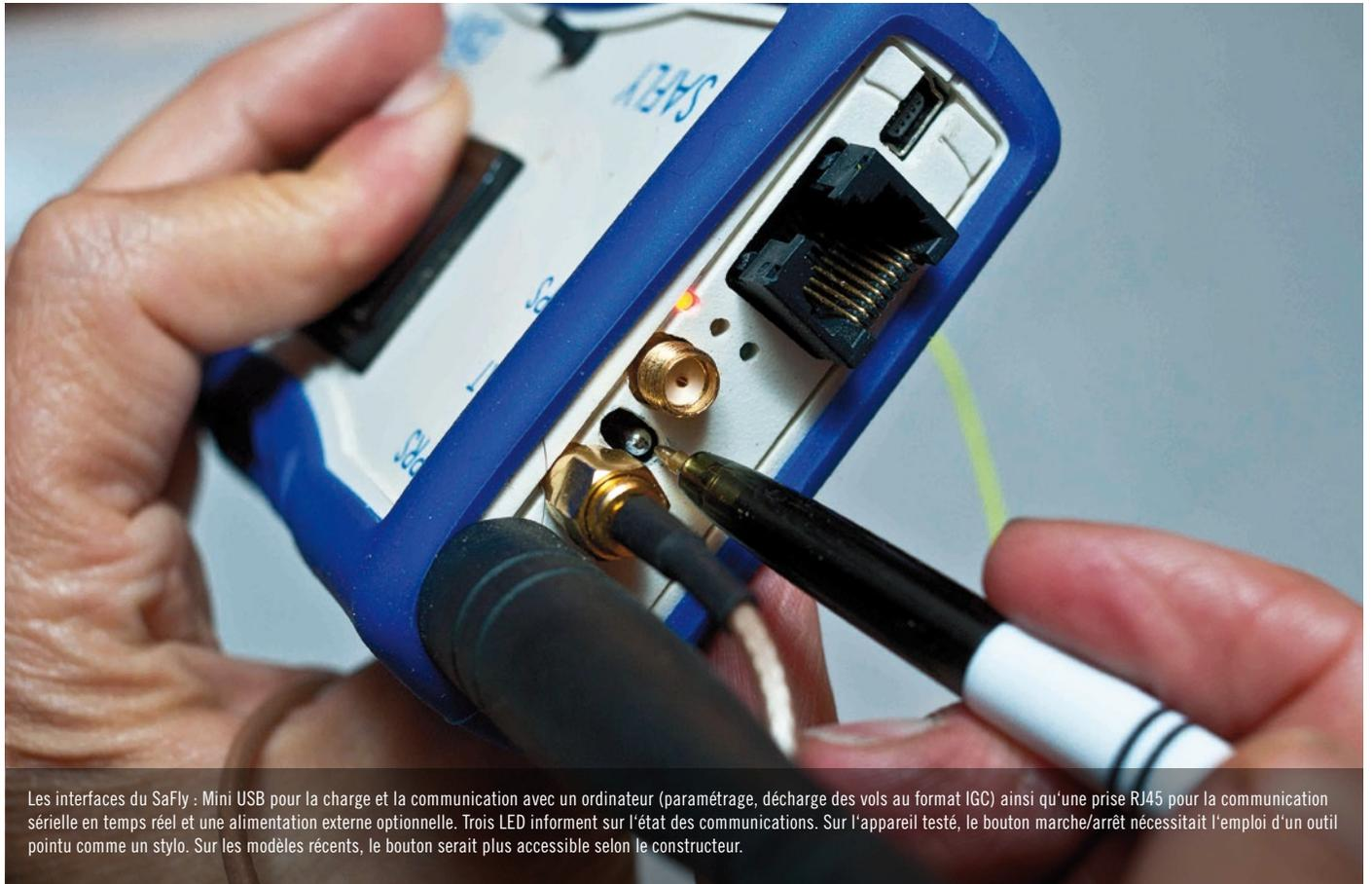
Les interfaces du SaFly : Mini USB pour la charge et la communication avec un ordinateur (paramétrage, décharge des vols au format IGC) ainsi qu'une prise RJ45 pour la communication série en temps réel et une alimentation externe optionnelle. Trois LED informent sur l'état des communications. Sur l'appareil testé, le bouton marche/arrêt nécessitait l'emploi d'un outil pointu comme un stylo. Sur les modèles récents, le bouton serait plus accessible selon le constructeur.
