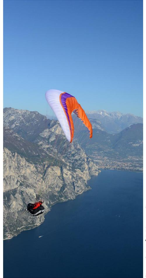
UNE BELLE SÉQUENCE DE DÉCROCHAGE : LE PILOTE RALENTIT, RALENTIT... LA VOILE S'ARRÊTE DE VOLER ET CESSE DE PORTER...
