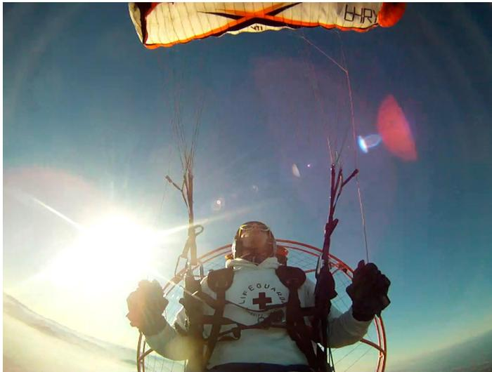
Pour calmer la situation, il faut remonter les mains régulièrement et symétriquement, jusqu'à trouver la marche arrière. Ici on commence à voir l'aile se reconstruire progressivement. La situation se stabilise, les oreilles sont repliées vers l'arrière, c'est le début du vol en marche arrière.
