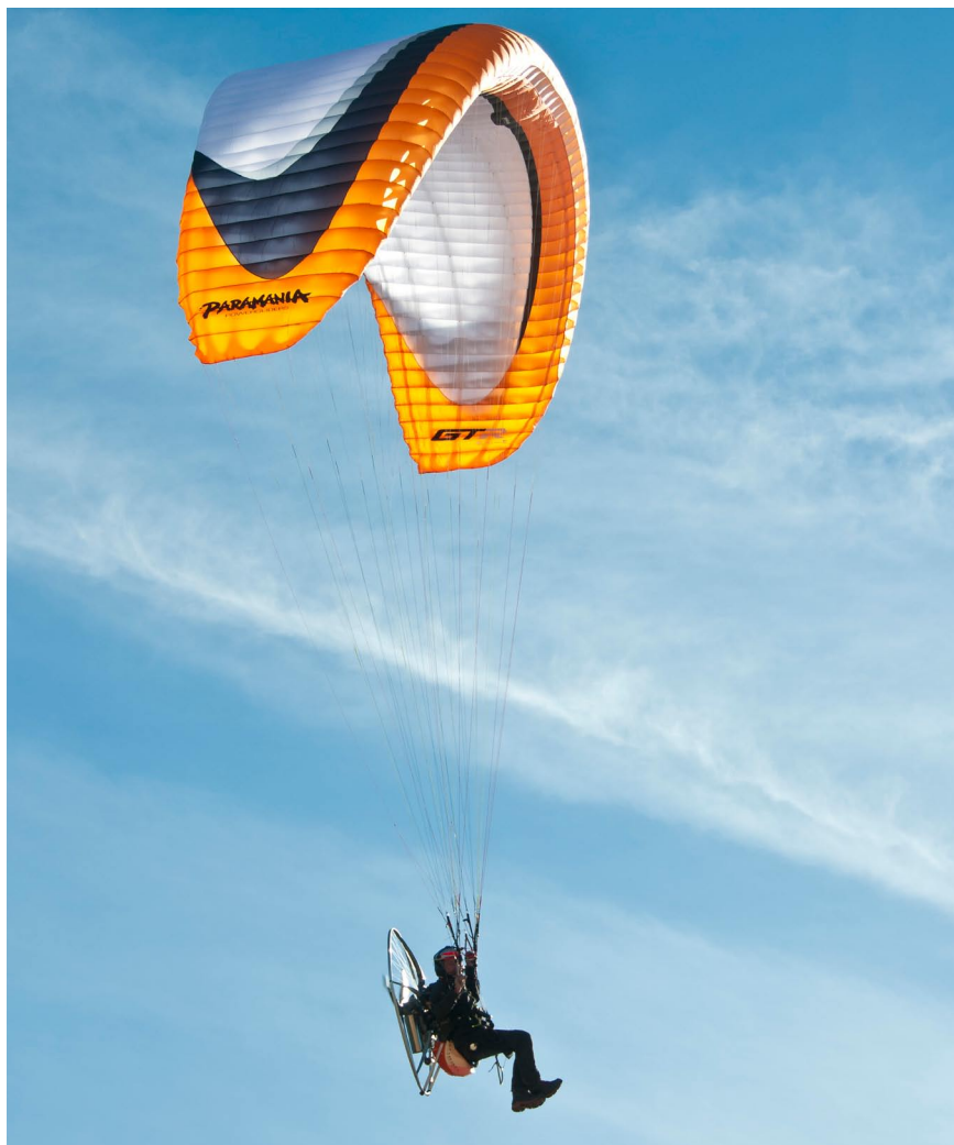
Au milieu de l'aile, une sorte de quille comme sur toutes les ailes récentes de Paramania. Selon le constructeur, le volume plus important au centre augmente la solidité de la partie centrale et empêche la déformation de l'aile lors d'un pilotage par transfert de poids.
