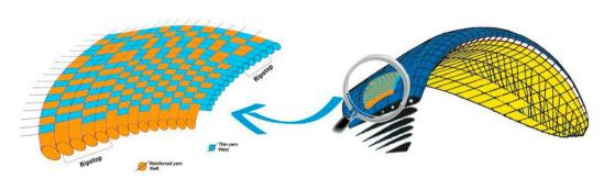
L'idée brevetée : les fils pour la chaîne et la trame ne sont pas du même diamètre.
