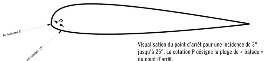
Visualisation du point d'arrêt pour une incidence de  $3^\circ$  jusqu'à  $25^\circ$ . La cotation P désigne la plage de « balade » du point d'arrêt.
