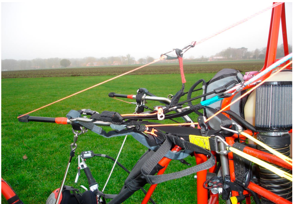
Assistanat ? Les A assistés sont de série sur le Flyke, il s'agit de suspentes agissant sur les A au gonflage, sans qu'une intervention du pilote ne soit nécessaire. Certains pilotes de Flyke ne les utilisent pas, mais préfèrent accompagner les élévateurs à la main. Photo : Fresh Breeze
