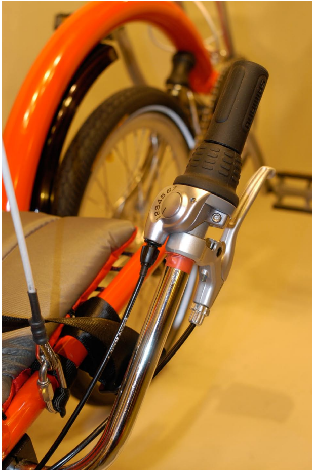
Le levier faisant office de guidon. On tire pour tourner à droite, on pousse pour tourner à gauche. Photos : Sascha Burkhardt
