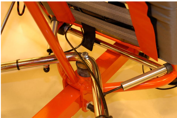
A la mise en virage sur la route, le Flyke s'articule autour de ce point de pivot au-dessus du silent-bloc central.
