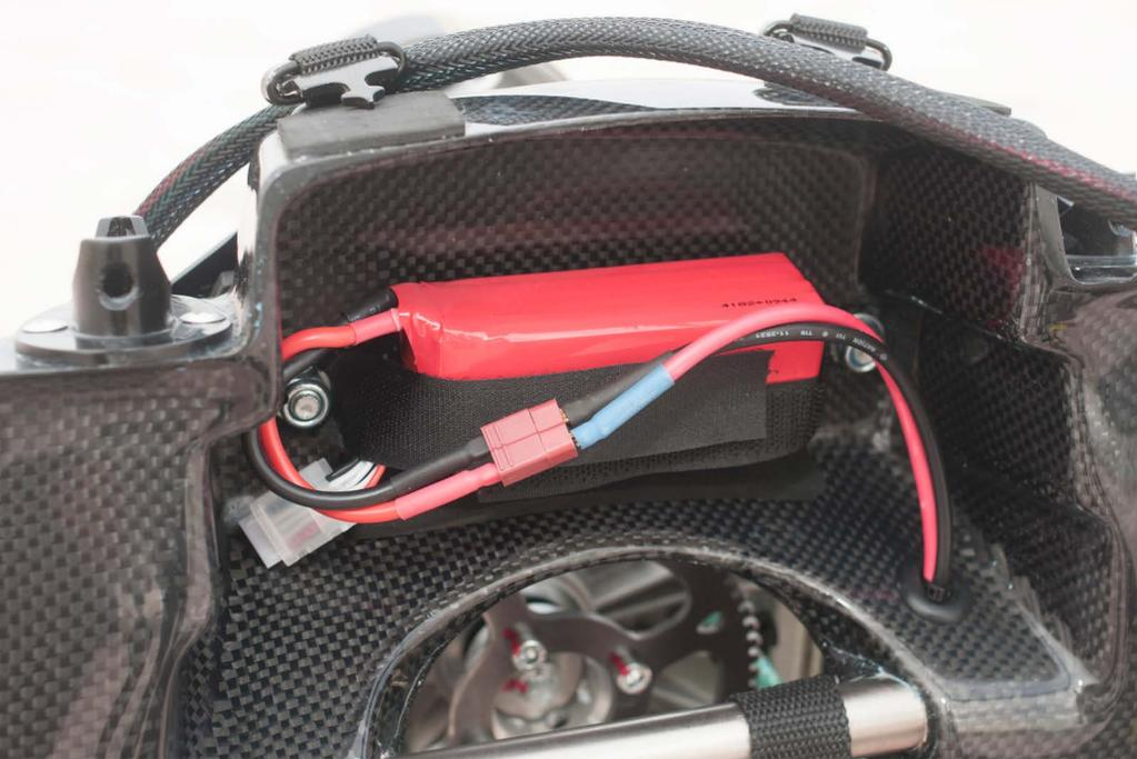
Une des mesures pour économiser du poids : le compartiment de la batterie n'a pas de couvercle. On s'en passe sans problème.
