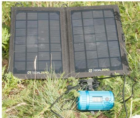
Le Powermonkey 2 est étanche, et le long câble est retenu par le couvercle vissé sur le joint. Cela l'empêche aussi de se défaire dans le sac à dos. On peut recharger le Powermonkey 2 avec un panneau solaire portable.
