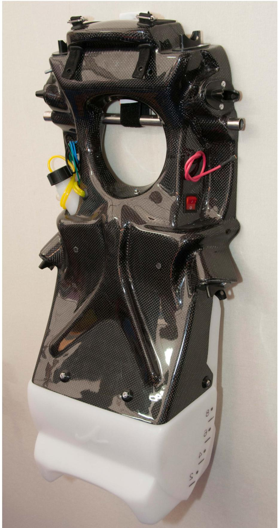
Le résultat est clairement spectaculaire au niveau du poids. Il n'y a que le système d'attaches qui ne semble pas aller avec le reste: de gros tubes fixés par des boulons énormes. Mais c'est assumé: comme l'explique Emmanuel Layan, au niveau accroche, il n'était pas question d'aller trop loin dans l'allégement.
