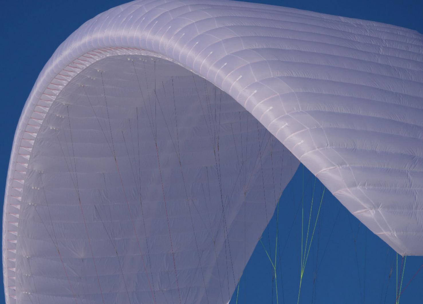
La Tenor (EN B) en phase de prototype chez Phi: un look prometteur. À noter les loops permettant de varier les points d'accroche A sur ce prototype. C'est une aile proche de la Symphonia, mais avec un autre profile et différentes tensions. L'allongement est identique.
