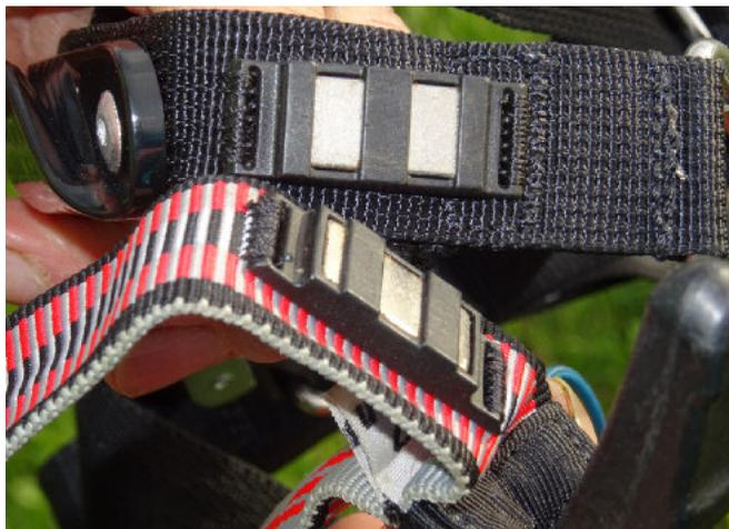
Astucieux: la forme de ses aimants cmet les poignées automatiquement parallèles à l'élévateur, quelque soit l'angle sous lequel on les présente.
