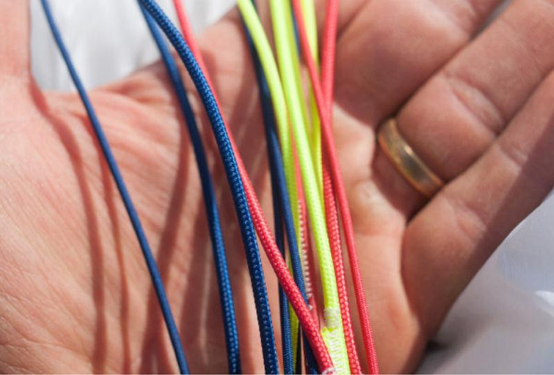
Des suspentes Edelrid Kevlar de l'étage inférieur.
