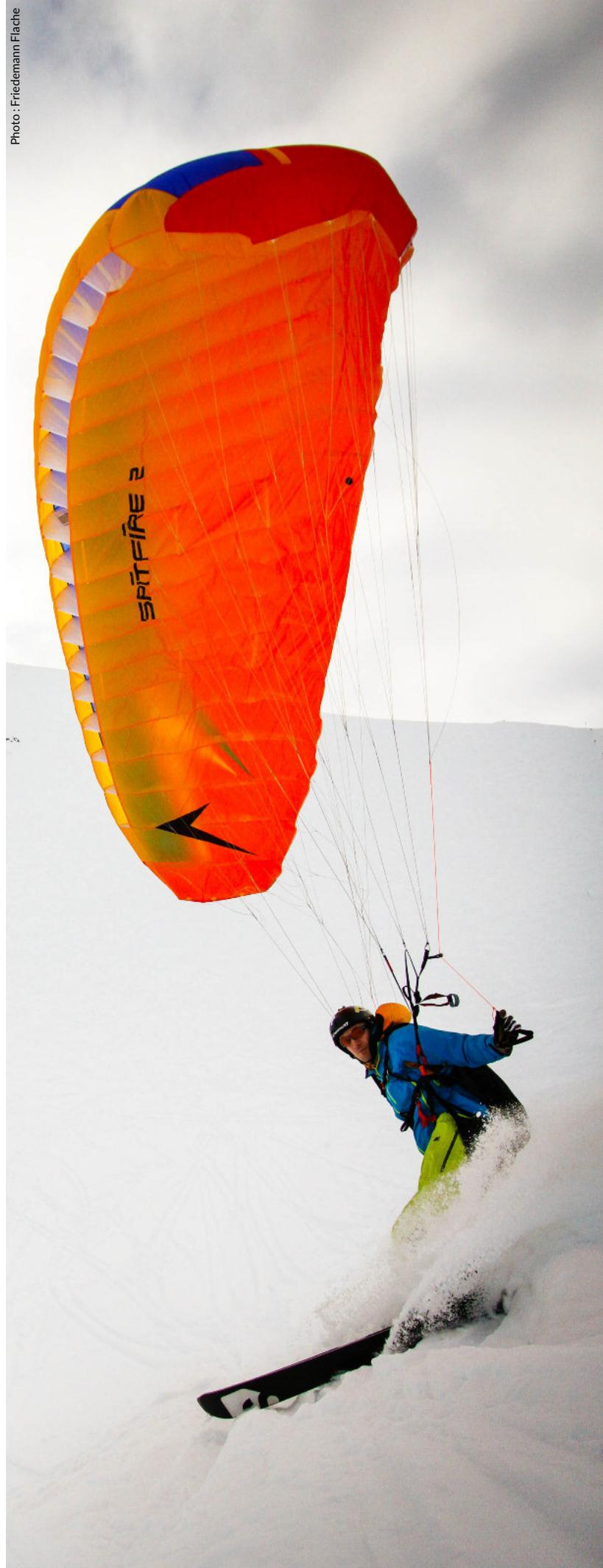
La Mirage RS: Une voile Speedriding qui bénéficie du système RAST, qui a déjà fait ses preuves dans les parapentes de Swing comme la Mito RS et l'Arcus RS. Une cloison avec des soupapes permet de mieux garder la pression interne dans la partie arrière de l'aile.
