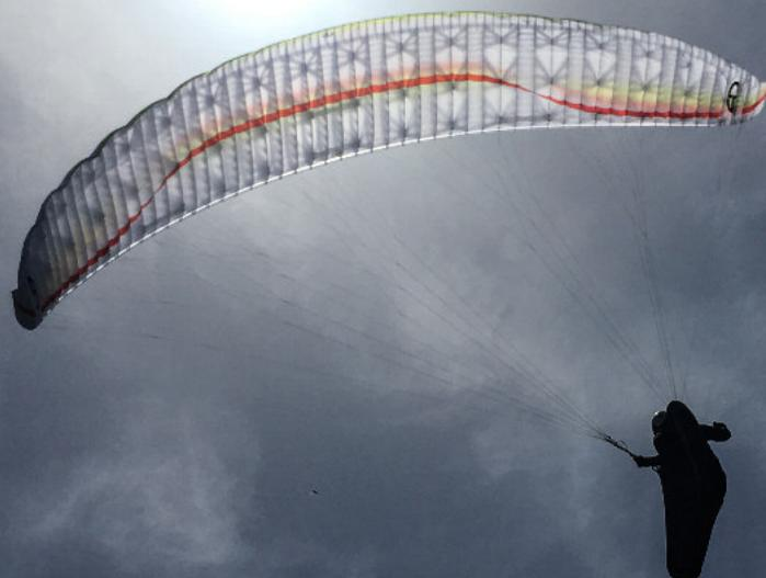
Cette Héro taille SM, donnée pour un PTV de 80 à 95 kg, est intégralement construite en Porcher Skytex 27 gr (Hard finish pour les cloisons et diagonales). Le suspentage à 3 étages, intégralement dégainé, étaye la voûte toutes les 3 alvéoles. La structure interne, sans bande transversale intégrale, est renforcée de diagonales allégées au maximum.
