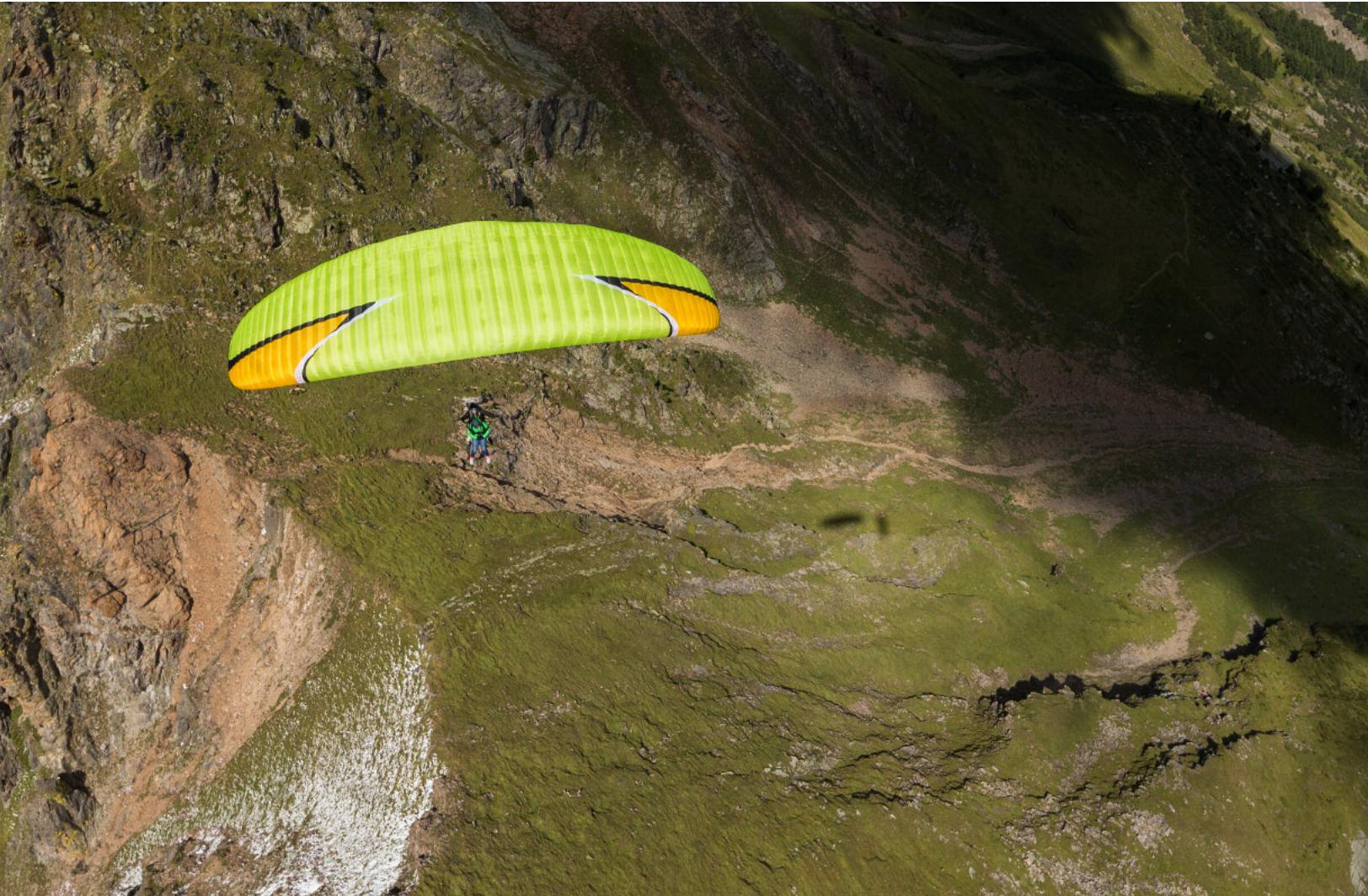
Bien visible: le 3D-Shaping en bord d'attaque et en bord de fuite
