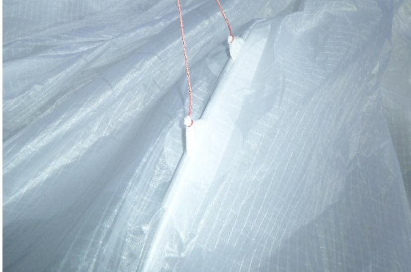
L'examen du bord d'attaque, 3D shape, dévoile un jonc contraint, court qui donne sa forme au shark nose. Une double rangée de A très rapprochée soutient ce dernier.
