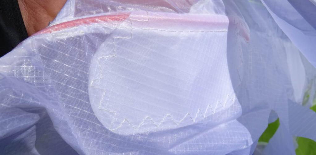
Renforts aux niveaux des A dans le bord d'attaque. ce dernier est optimisé pour le vol rapide.
