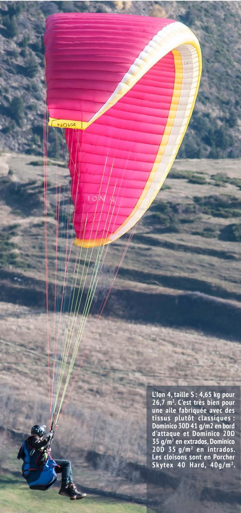
L'Ion 4, taille S : 4,65 kg pour 26,7 m<sup>2</sup>. C'est très bien pour une aile fabriquée avec des tissus plutôt classiques : Dominico 30D 41 g/m<sup>2</sup> en bord d'attaque et Dominico 20D 35 g/m<sup>2</sup> en extrados, Dominico 20D 35 g/m<sup>2</sup> en intrados. Les cloisons sont en Porcher Skytex 40 Hard, 40g/m<sup>2</sup>.
