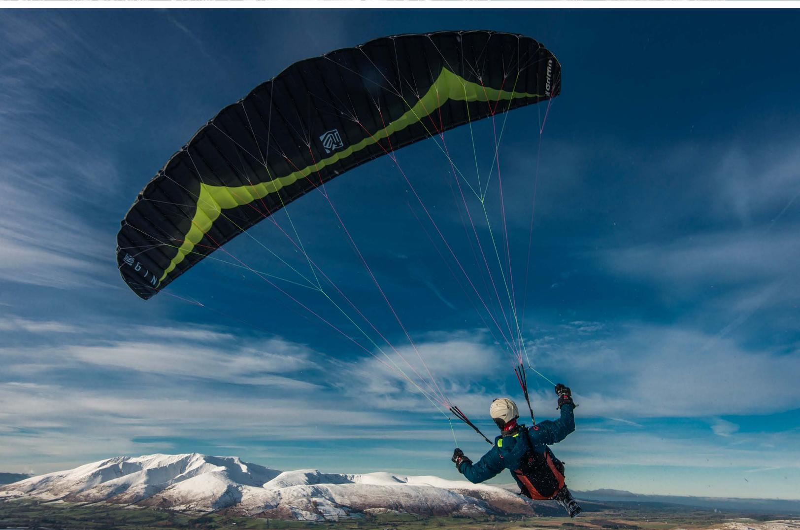
Fabriquée essentiellement en Skytex 27 g/m<sup>2</sup> sauf pour le bord d'attaque en Porcher Skytex 32 g/m<sup>2</sup>, elle ne pèse que 2,1 kg. Les élévateurs sont construits de manière classique, mais on peut en option la commander avec des élévateurs en Dyneema et des Softlinks.
