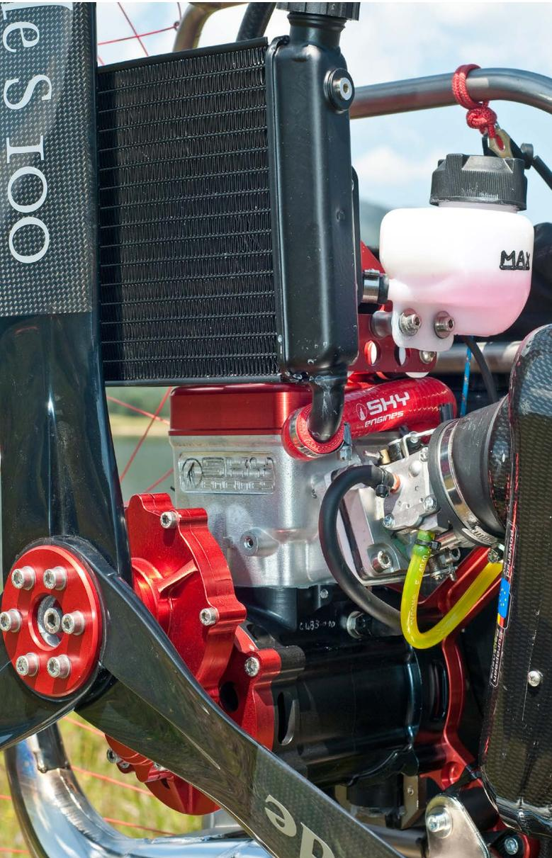
Pour comparaison, un moteur Sky, également refroidi par eau. Grandes différences : le radiateur est moins intégré, et il n'a pas de pompe du tout. C'est uniquement la différence de température qui entretient la circulation (principe thermosiphon).
