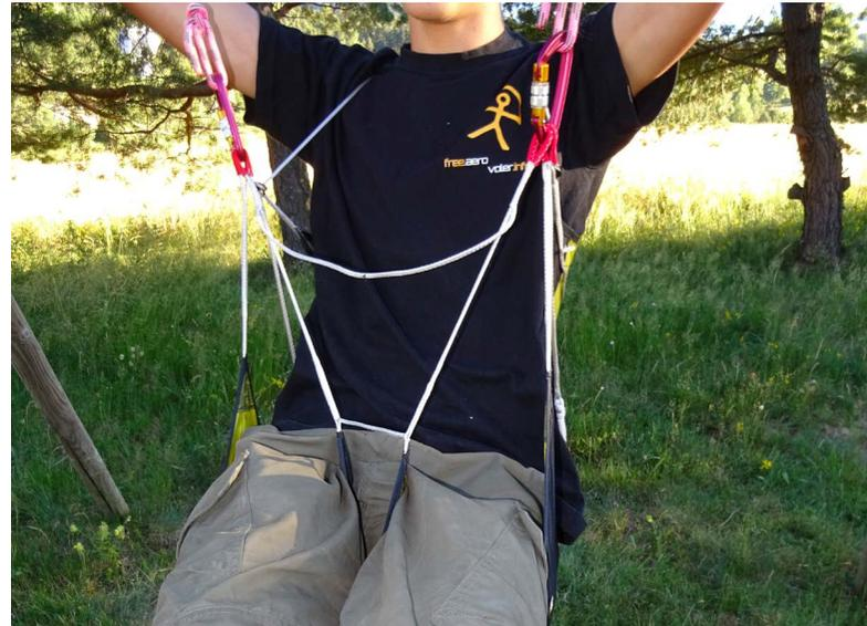
On peut l'utiliser soit avec des boucles soft links, ou alors avec des mousquetons légers comme ces Grivel. Derrière les deux points d'accrochage qui servent également de fermeture, un anneau à friction laisse coulisser librement la drisse "épaule arrière assise", cela permet de se redresser plus facilement.
