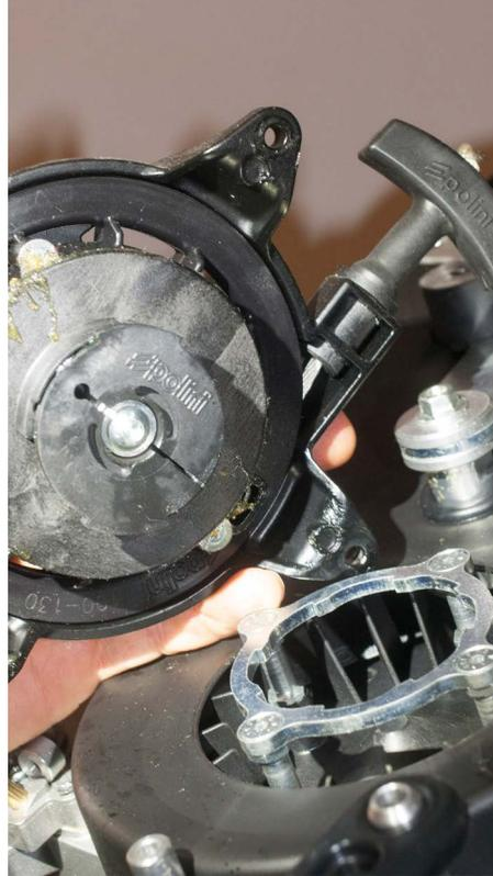
Pour changer la fixation du radiateur selon une mise à jour conseillée par le constructeur, nous avons dû démonter le Flash-Starter ...
