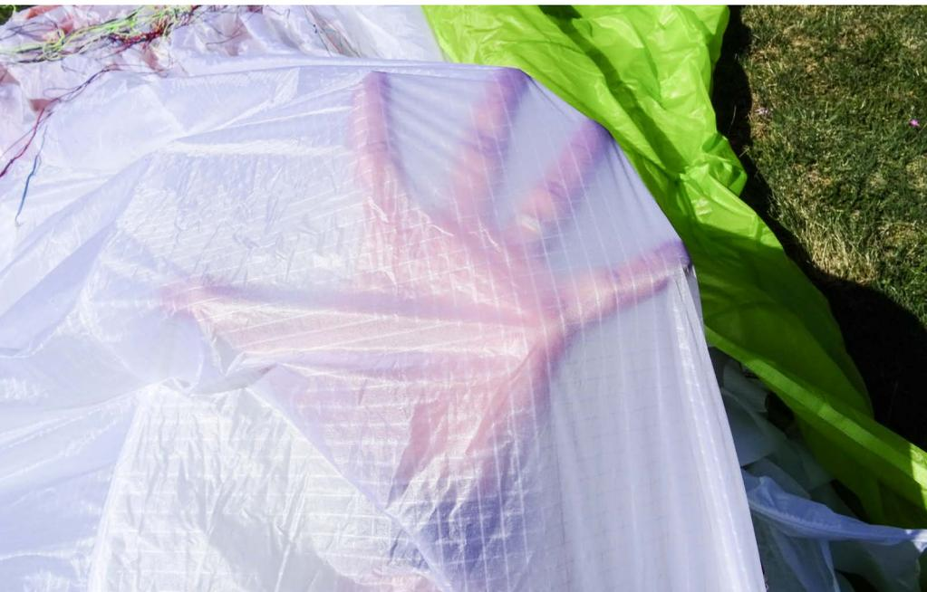
Le Porcher Skytex 27 paraît naturellement plus fragile, mais placé dans l'intrados, il reste peu exposé mécaniquement.
