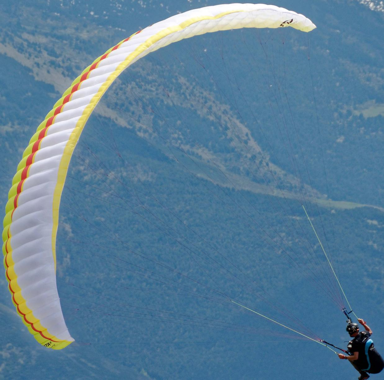
L'aile balance légèrement sur l'axe du roulis avant de finir par se stabiliser, mais elle ne shoote pas. Même en se penchant au maximum du côté fermé, la voile reste en ligne droite. Les exigences du cahier de charges au niveau de la sécurité semblent absolument atteintes.
