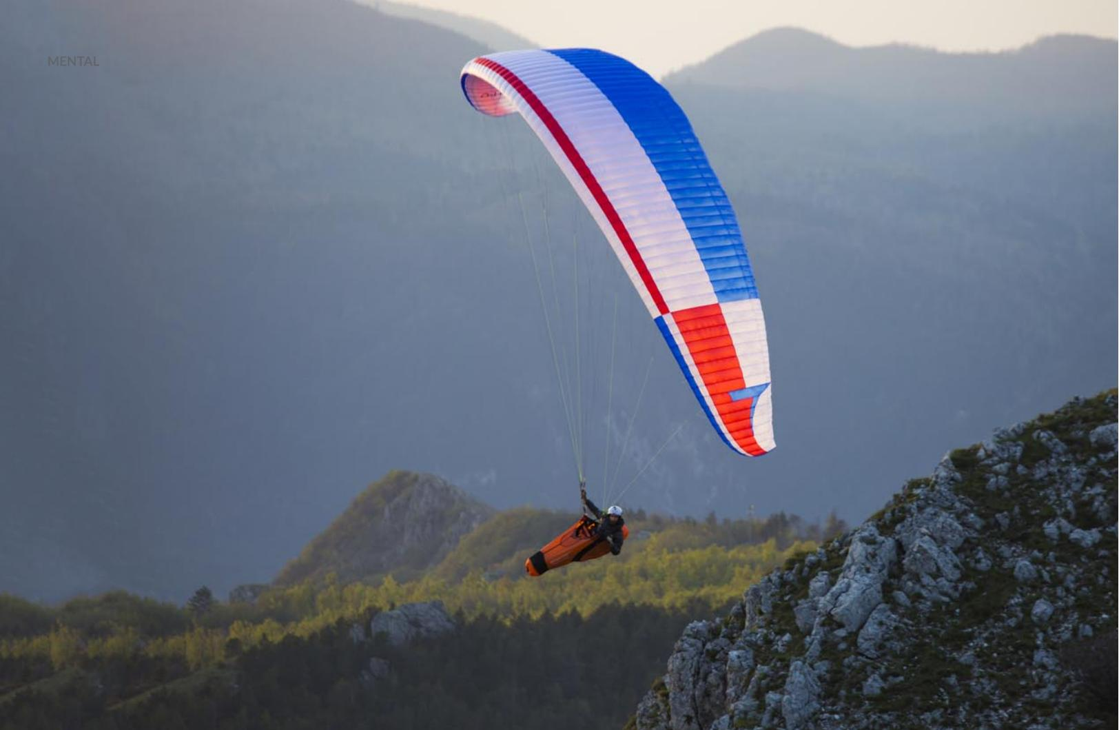
Dorénavant, la Queen 2 existe aussi en "Light": la Q-Light pèse presque 1 kg de moins en taille MS (4,3 au lieu de 5,1), entre autres grâce à l'utilisation de Skytex 27 sauf en bord d'attaque (Dominico D30).
