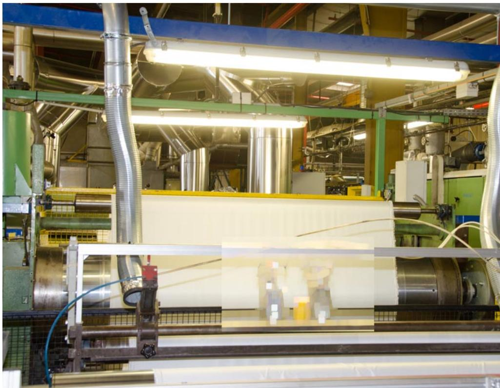
La machine pour l'enduction du tissu. celle-ci tourne aux solvants "agressifs", mais les vapeurs et gaz sont récupérés.
