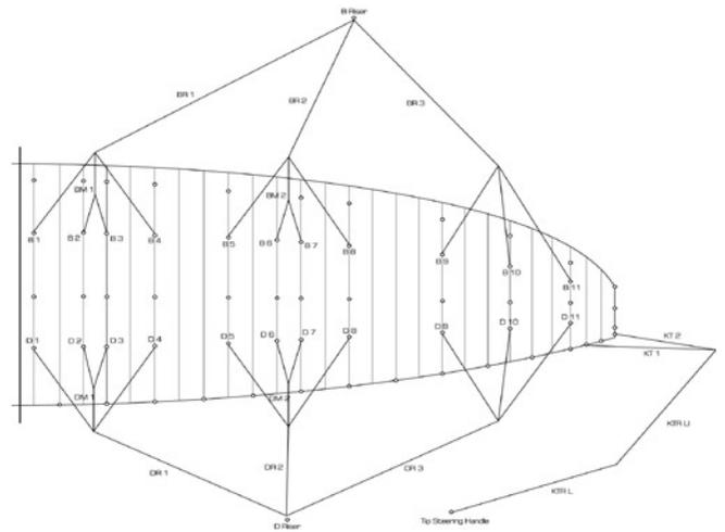
Petite cause, grand effet : la commande pour le pilotage aux wingtips n'agit que sur deux points au niveau du stabilo (schéma ci-dessus). Pourtant, elle permet un pilotage étonnamment efficace.
