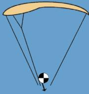
Le pilote active le frein gauche. Le "volet de frein" ou plutôt "l'aileron" augmente temporairement la portance côté gauche. Suite à cette augmentation...
