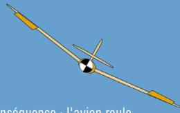
Conséquence : l'avion roule immédiatement vers la droite. Les ailerons sont d'autant plus efficaces que le centre de gravité se trouve au milieu des deux ailes.
