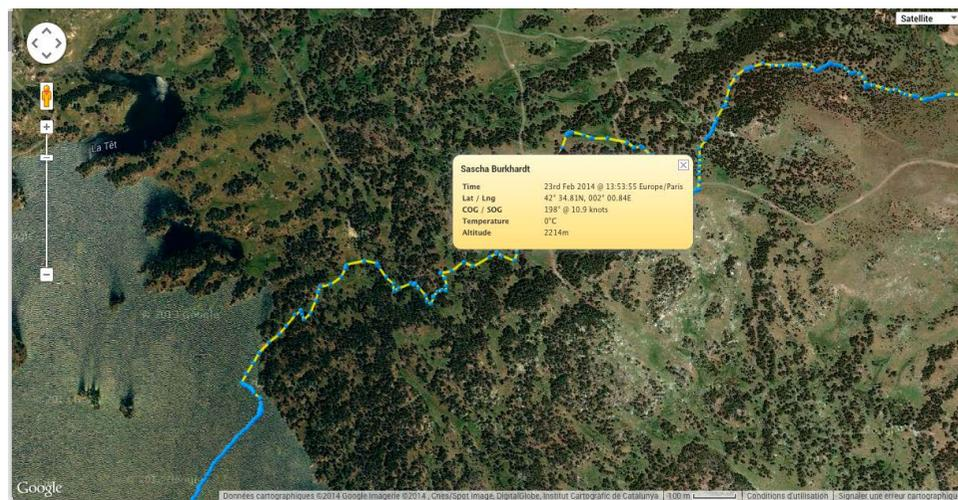
Un tracé du Yellowbrick en mode rapide "Burst" lors d'un essai au niveau du sol: il a publié une position toutes les 5 secondes, en transmettant les positions par paquets de 3 (donc une transmission toutes les 15 secondes). C'est un mode très détaillé, mais aussi très cher: en une heure, 30 euros de crédits "anéantis". Un tracking aussi précis n'est évidemment pas nécessaire en utilisation normale, et le Yellowbrick sait aussi tracker de manière plus économe...
