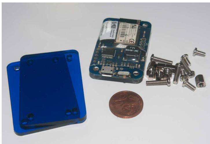
En moins d'un quart d'heure, l'appareil est prêt à l'emploi. Il pèse environ 40 grammes. La platine est partiellement couverte d'un film, mais l'instrument est loin d'être étanche aux poussières ou à l'eau. Le boîtier largement ouvert contribue en revanche aux qualités acoustiques du vario: le son est fort et clair, à ce niveau l'appareil se situe parmi les meilleures du marché. La sensibilité est également très bonne.
