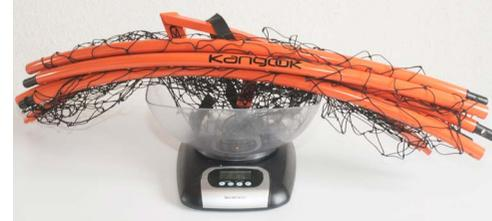
Encore un constructeur qui se met aux cages fagot : RSultra pour ce Kangook Trekk avec cage Trekk. Là aussi, ce n'est pas seulement le gain en poids qui prime, mais le volume de la machine démontée. La cage fagot pèse 2 100 grammes, la cage "en dur" Viking 2 930 grammes, cela fait une économie de 830 grammes. Mais surtout, la cage à fagot rentre dans un sac à main...
