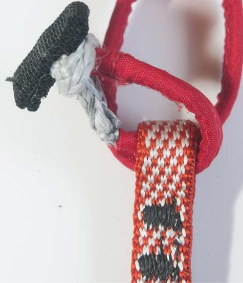
Pas bien : fermeture correcte, mais le connecteur n'est pas correctement doublé. Même résultat qu'à gauche : résistance divisée par deux.
