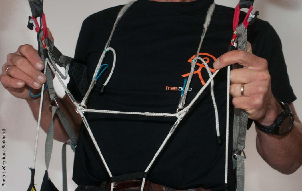
Le pilote apprend vite à faire confiance à ces "ficelles" de Dynalight en 3 mm. Leur résistance nominale à la rupture est de 1100 kg. Après épissure, elle descend à 900 daN. Amplement suffisant !
