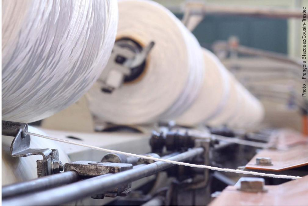
La fabrication d'une tresse en Dyneema chez Cousin-Trestec. Chez ce fabricant, les fibres Dyneema en provenance de la société néerlandaise DSM, propriétaire de la marque Dyneema, sont tressées et enduites en fonction des besoins.
