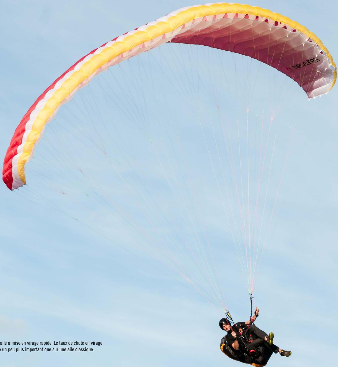
Une aile à mise en virage rapide. Le taux de chute en virage reste un peu plus important que sur une aile classique.
