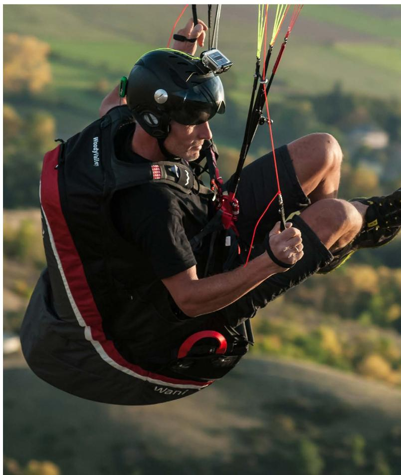
L'airbag de la Wani ne se gonfle pas par le vent relatif, mais il est tenu en forme grâce à un ressort intégré. Au décollage, le dispositif est en conséquence immédiatement opérationnel et protège le pilote pendant la course d'élan.
