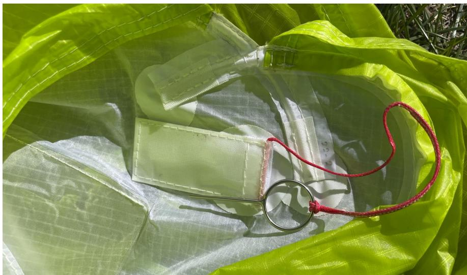
Praktische Details: Haken zum Fixieren der Eintrittskante an einem steilen Hang, und Befestigungen für die Tragegurte beim Packen.
