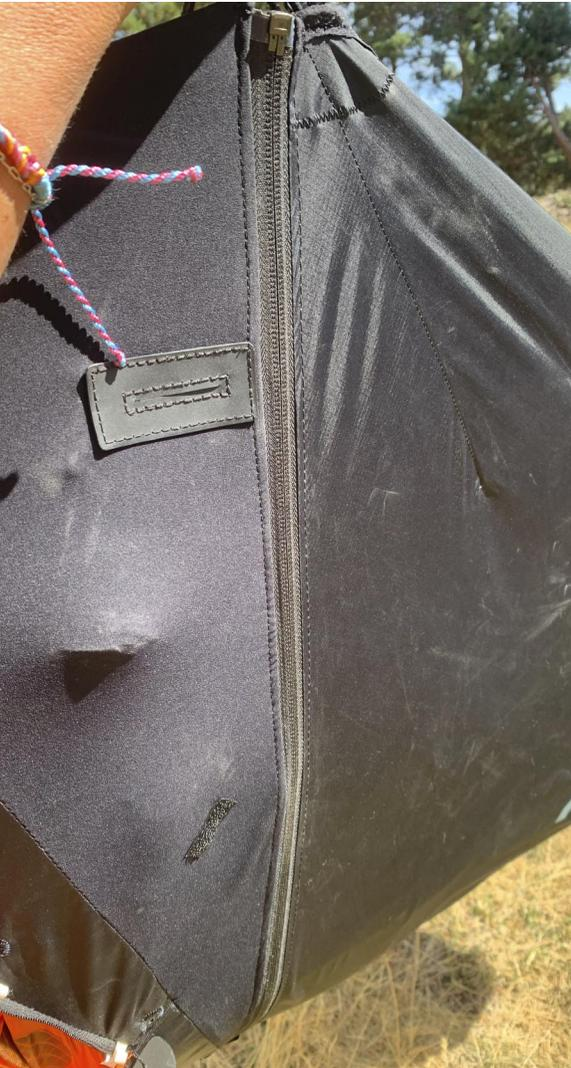
Die empfindlichen Stellen wurden verstärkt, wie z.B. der Durchlauf des Beschleunigers. Trotz seiner Leichtigkeit ist das Gurtzeug mit einem Reißverschluss zum Abbauen ausgestattet.
