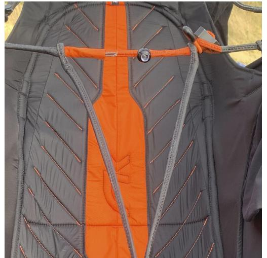
Der Frontverschluss ist mit der schwarzen Kugel in der Mitte verstellbar.
