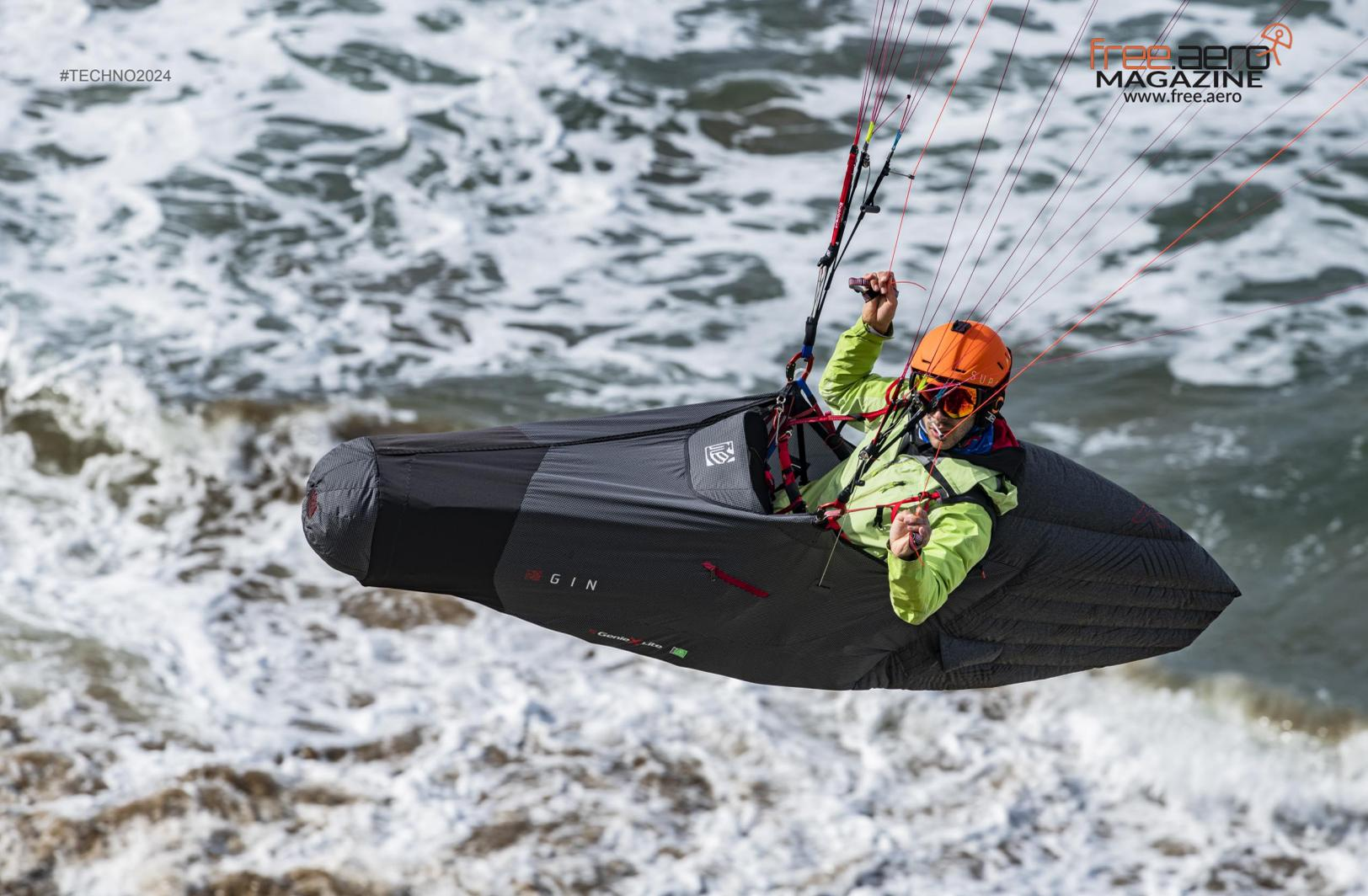
Gute aerodynamische Formstabilität, und die Heckflosse bleibt dank der ausreichend steifen Lufteinlässe gut gefüllt.
