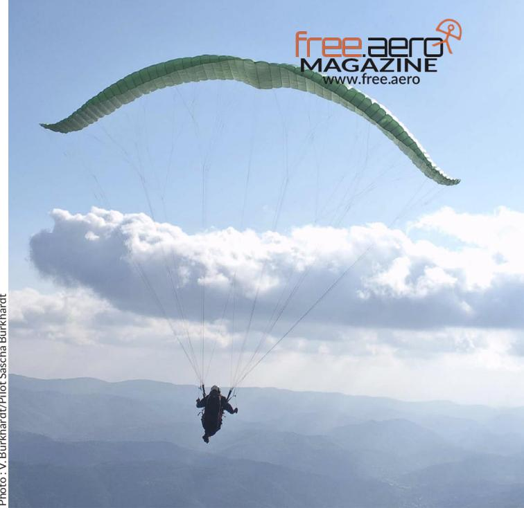
Vor zwanzig Jahren integrierte der Bionic, entworfen von Olivier Caldara, ungewöhnliche Elemente zur Reduzierung des induzierten Widerstands: Die Stabilos waren nach oben gebogen. Dadurch musste die Mitte des Schirms abgesenkt werden, um die Wölbung und die Gierachse zu stabilisieren.
