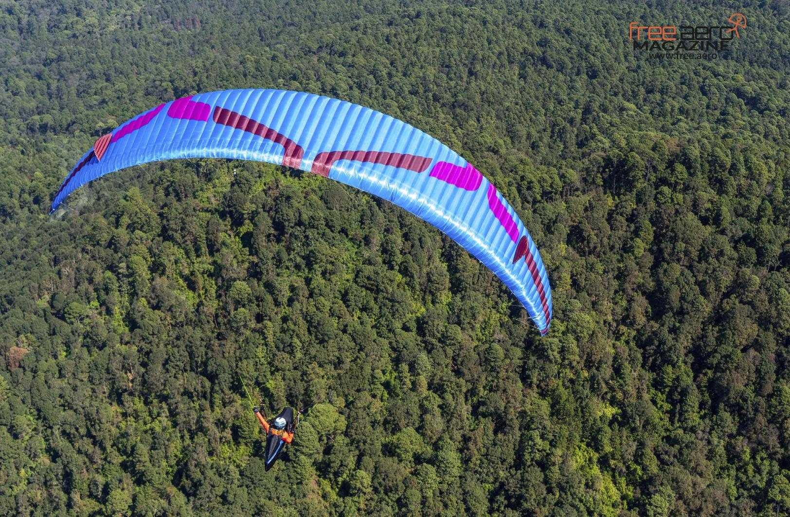
Kürzlich hat Ozone die Winglets, zum Beispiel beim Photon, wiedereingeführt, jedoch mit einem anderen Ansatz. Bei Ozone besteht das Ziel darin, eine stärkere Wölbung des Flügels (HiArc) zu ermöglichen, ohne dabei das Rollen zu verstärken oder eine Neigung zu unfreiwilligen Spiralen zu begünstigen. Die Verringerung des Rollens ist ebenfalls ein wichtiger Faktor für den Flugkomfort, was unter anderem die Anwesenheit von Winglets beim neuen Tandem Magnum 4 erklärt.
