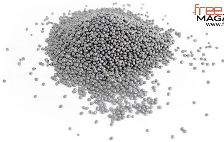
Inzwischen hat GIN begonnen, Protektoren mit „Aerobeans“ herzustellen: expandierten Polypropylen-Kugeln. Diese sind sehr leicht und bieten laut GIN viele Vorteile:
