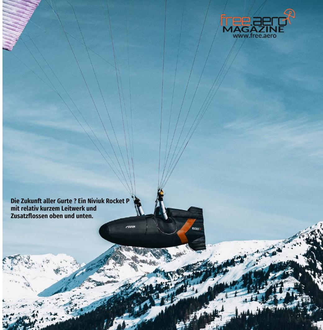
Die Zukunft aller Gurte ? Ein Niviuk Rocket P mit relativ kurzem Leitwerk und Zusatzflossen oben und unten.
