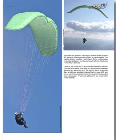
Il y a vingt ans, le Bionic, conçu par Olivier Cadoux, intégrait des éléments robotisés pour réduire la traînée inutile : les stabilos étaient courbés vers le haut. Cette configuration nécessitait d'abaisser le milieu de la voile afin de stabiliser la voile et l'axe de vol.
