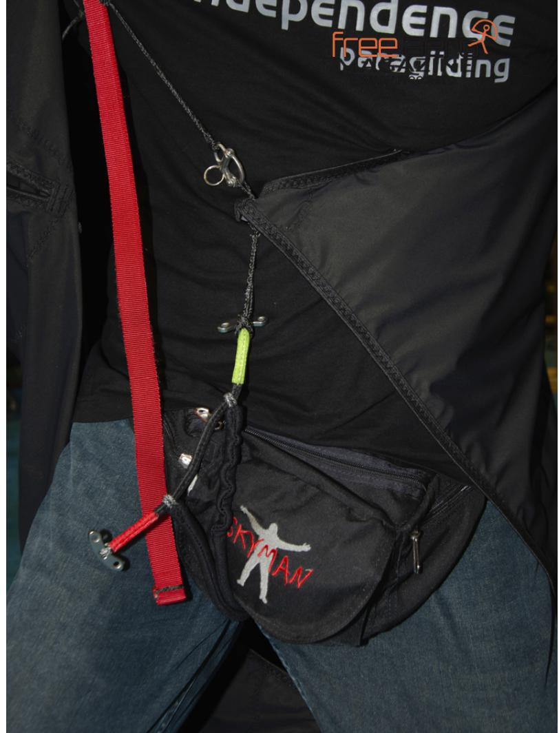
Independence/Skyman-Chef Stefan Kurrle arbeitet auch in den EN-Gremien mit; natürlich hat dieses Gurtzeug bereits die neue Herausfallsicherung integriert, die 400 kg, also mehr als das Vierfache des Pilotengewichts, auch bei geöffneten Beingurten aushalten muss. Gleichzeitig wurde das Verhältnis von Auge zum Knebel am Verschluss neu abgestimmt: selbst ohne elastische Schlaufe scheint ein unbeabsichtigtes Öffnen unmöglich.
