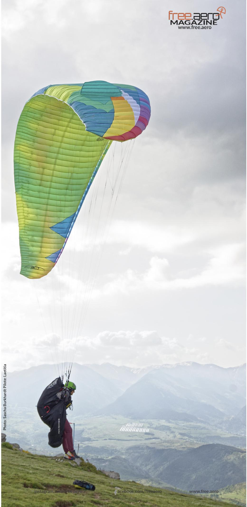
BGD erklärt, dass dieses erstaunliche autostabile Verhalten (hier beim Diva 2, aber auch beim Base 3 vorhanden) durch ein eher leichtes Reflexprofil erreicht wird, das sich dank anderer Konstruktionsparameter voll entfalten kann. Unter anderem muss die Konstruktion sehr sorgfältig ausgeführt werden, damit der Reflex-Effekt nicht verloren geht. Und auch, um gute Leistung zu erhalten: Ein Reflexprofil ist grundsätzlich eher weniger leistungsstark als ein klassisches Profil.
