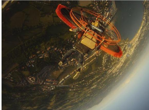
Hier ist die Art und Weise, wie der PowerLoop angegangen wird, deutlich zu erkennen: Das "GTR"-Logo wird vertikal angegangen, nicht die Mitte des Flügels. In dem Moment, in dem das Foto aufgenommen wurde, gab es keine Bewegung mehr auf der Rollachse, sondern nur noch um die Nickachse. So erfolgt der Looping auf einer schiefen Ebene.
