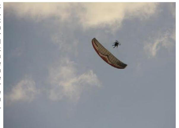
Mit einem 29-PS-Motor (Thor200) gelang es, etwas mehr Spannung in den Leinen zu halten.
