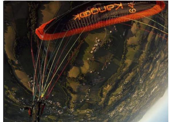
Ozone Viper 120m<sup>2</sup>, fast senkrechter Durchgang. Dieser Flügel hatte sich gut für das Spiel mit dem Powerloop geeignet, da er die nötige Leistung und Energie hat, um auch mit einem eher schwachen Motor sehr gute Energieumsetzung beim Flaren zu schaffen. Die Bremsen wurden hier sehr stark durchgezogen, um die Spannung in den Leinen zu halten.
