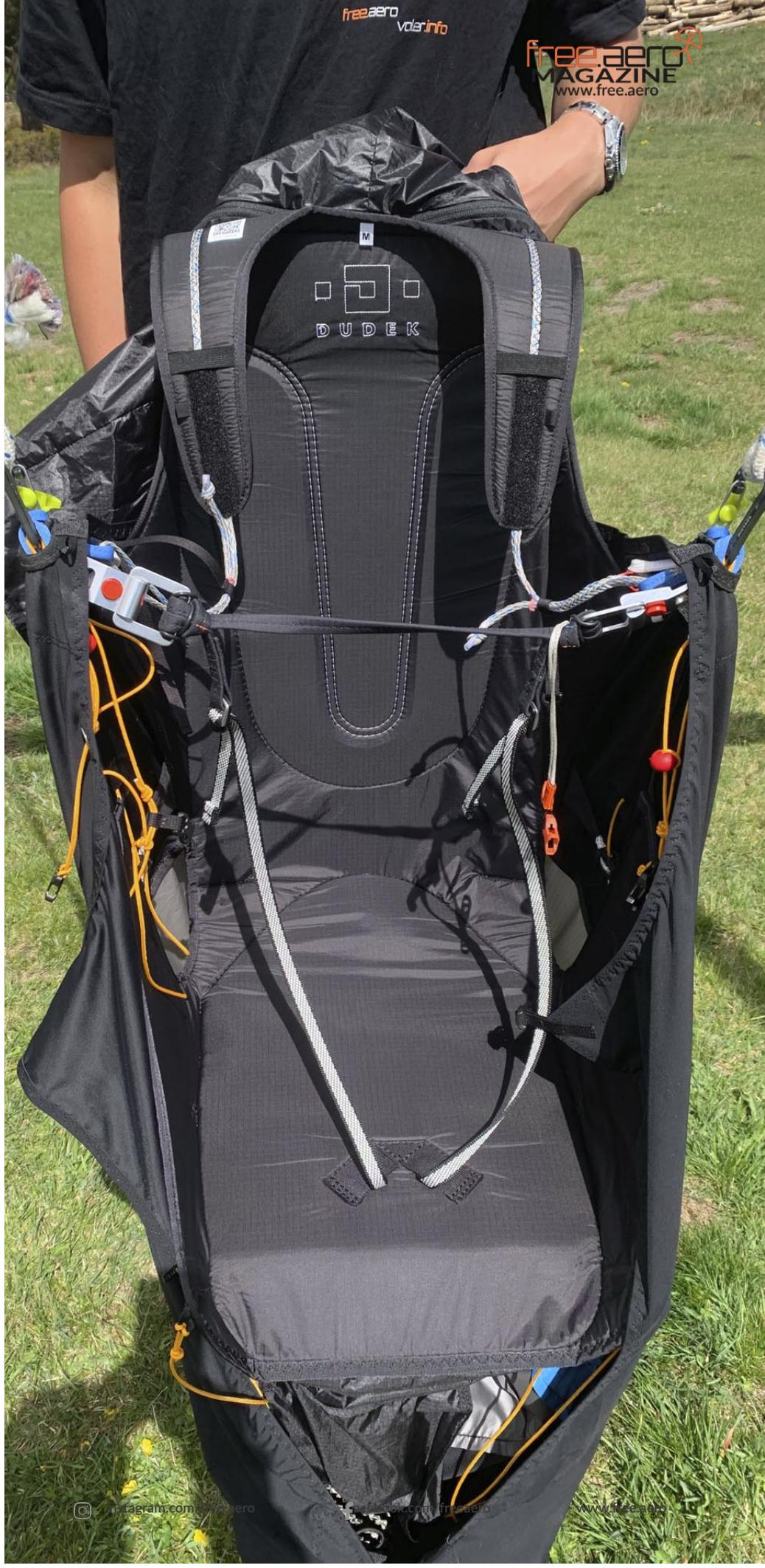
Die Beingurte des GetUp sind langenverstellbar, was eine Art Kreuzverspannung darstellt und richtig eingestellt fur mehr Rollstabilitat sorgt.
