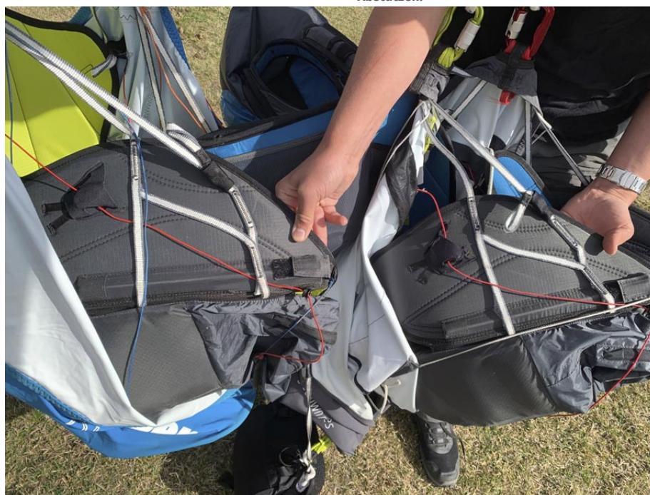
Beim Grasshopper (links im Bild) ist der Notschirm nur am Brustgurt befestigt, und seine Befestigungspunkte werden in den Hauptkarabiner eingehängt und schließen das Gurtzeug auf praktische Weise. Beim Sock ist der Rettercontainer am Kokon befestigt und der Retter an den Schultern aufgehängt. Der Verschluss des Gurtzeugs erfolgt über Knebel, die in Schlaufen gesteckt werden. Das ist weniger praktisch. Dafür kann der Notschirm des Grasshoppers bei der Startvorbereitung über den Boden schleifen.
