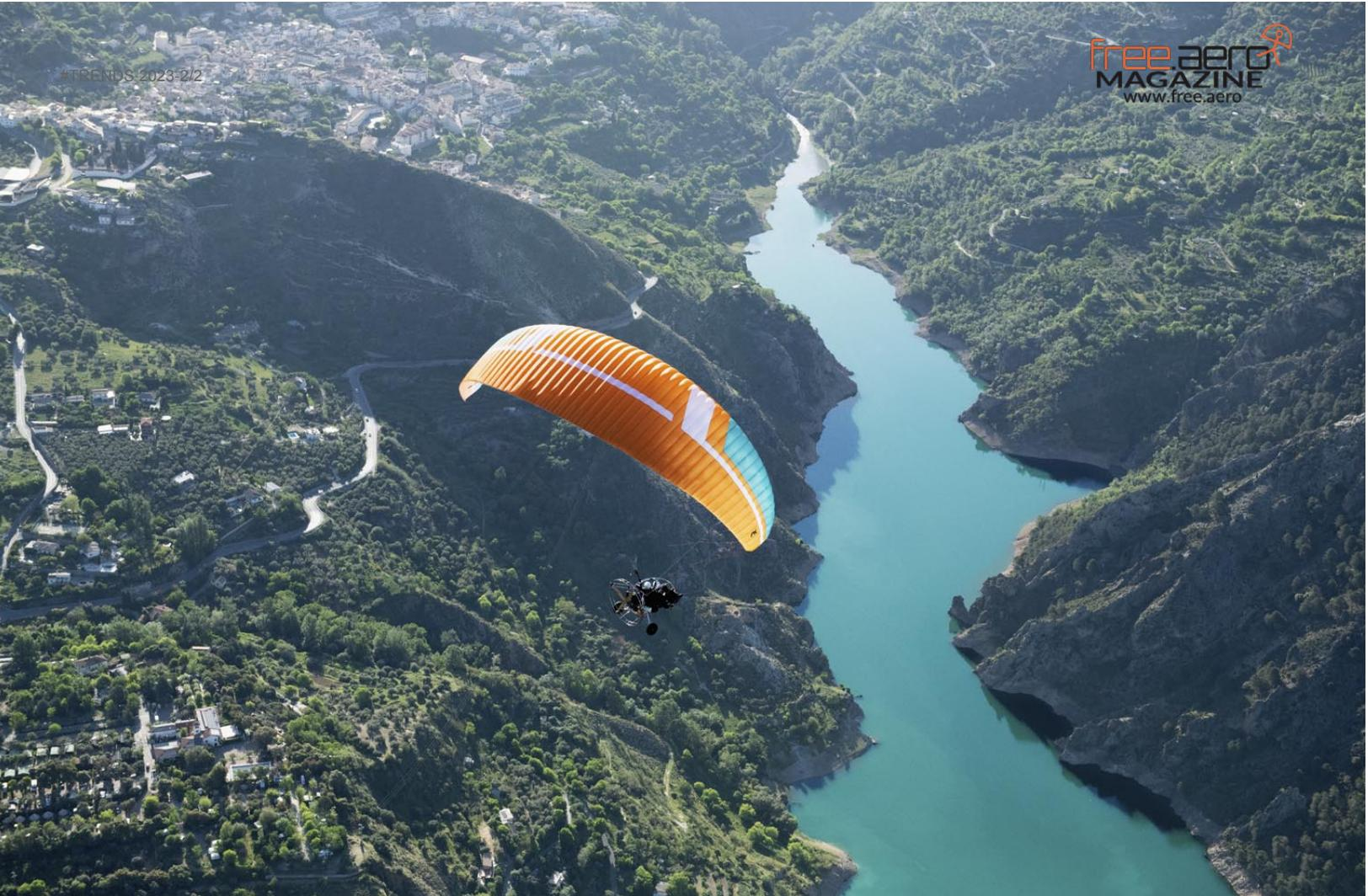
Beim Stubai-Cup beworben, aber nicht dabei: der neue R-Bus Version 2 von Niviuk. Mit 4 Größen von 31-40 m<sup>2</sup> und einem Gesamtgewichtsbereich von 100-600(!) kg wird dieser Tandem-Paramotorschirm als stabiler als die Vorgängerversion und mit einem erweiterten Geschwindigkeitsbereich beworben, der es ermöglicht, mit niedrigerem Speed zu starten und zu landen.
