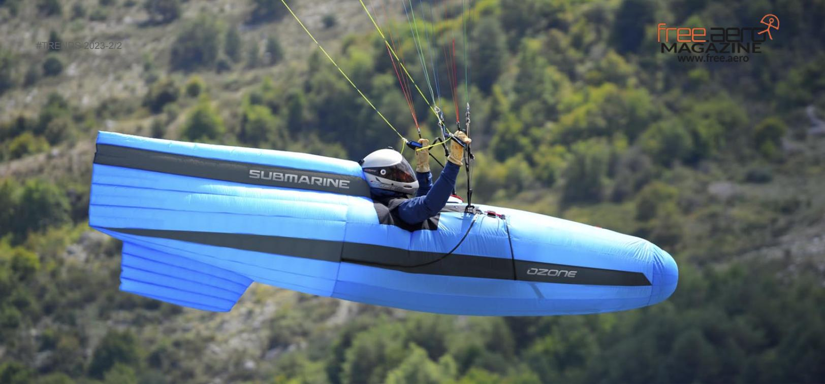
Die fast hermetische Verkleidung des Kokons beim Submarine mit seinem internen Überdruck (ca. 60 Pa, entspricht ca. 5m Höhe) bringt zwei neue Probleme mit sich: Die Instrumente sind nicht leicht zugänglich, und die Genauigkeit der barometrischen Messungen kann bei kleinen Änderungen/Bewegungen leiden (Instant-Vario bei Systemen, die die Werte in komplexen Algorithmen zusammen mit Gyrometer, Beschleunigungsmesser integrieren).
