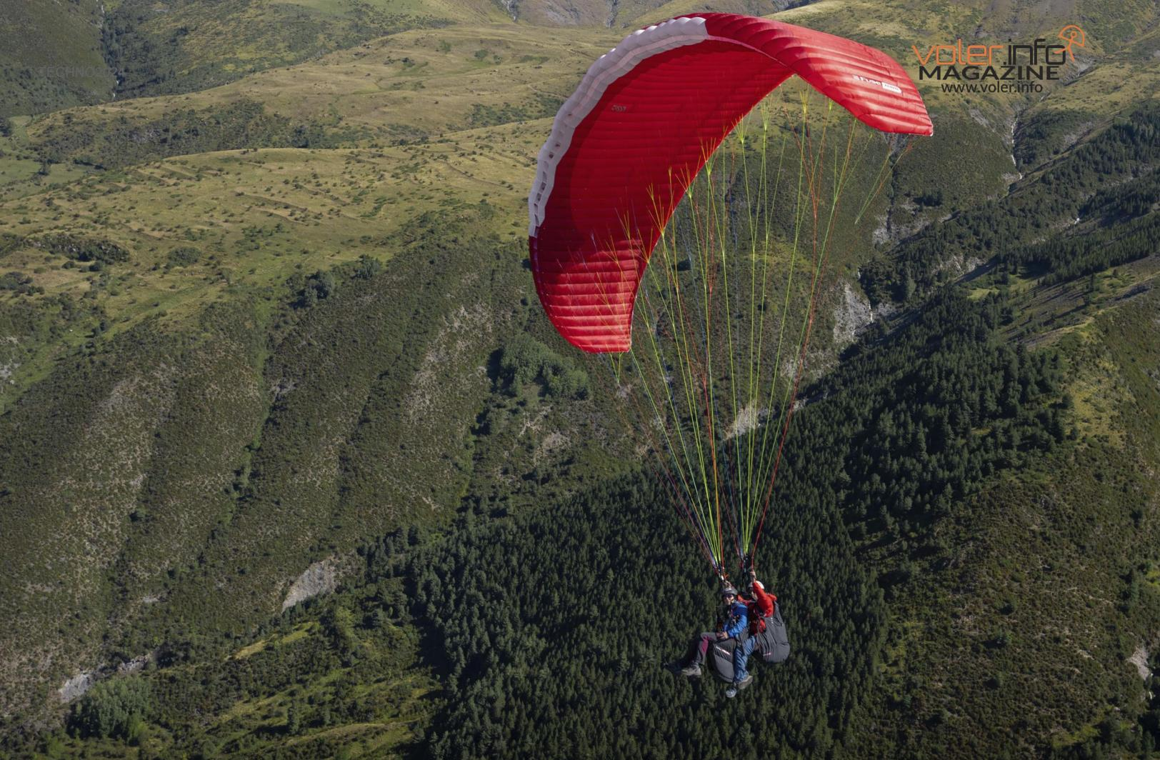
Un nouveau biplace: le Fuse Mini est muni du système WLE en bord d'attaque. Basé sur le Fuse 4, il a reçu, en plus du bord d'attaque ondulé, une légère réduction de l'allongement. Il serait très facile à manier lors de décollages ventés, avec un très bon amortissement en turbulence. Il permet aux pilotes légers de voler avec des passagers adultes légers ou des enfants.
