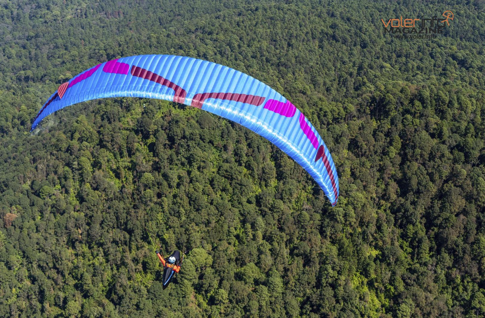
Plus récemment, Ozone a réintroduit les winglets, par exemple sur la Photon, mais avec une approche différente. Chez Ozone, l'objectif est de permettre une voûte plus importante de l'aile (HiArc), sans pour autant accroître le roulis ou provoquer une tendance à maintenir involontairement des spirales en 360°. La réduction du roulis est également un facteur important pour améliorer le confort en vol, ce qui explique, entre autres, la présence de winglets sur le nouveau biplace Magnum 4.
