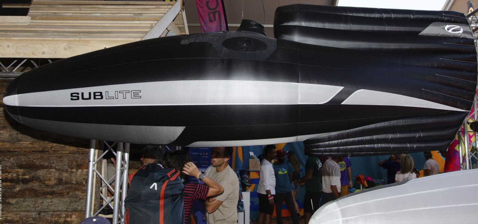
Ozone présente la version commercialisée de son Sublite. Il est très confortable, relativement facile à mettre en œuvre (pour des raisons de sécurité anti-oubli, il n'y a quand même qu'une jambe qui s'ouvre. Choix discutable?) La structure est celle des F\*race2/F\*lite2 : ce sont les fils Dyneema qui supportent la charge, pas le tissu.
