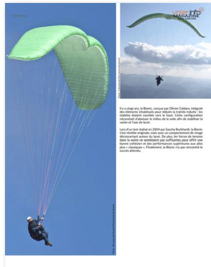
Il y a vingt ans, la Bionic, conçue par Olivier Cadere, intégrait des éléments stabilisants pour réduire la tâche requise. Les stabilisants étaient couchés vers le bas. Cette configuration permettait d'abaisser le milieu de la voile afin de stabiliser la voile et l'axe de l'axe.
