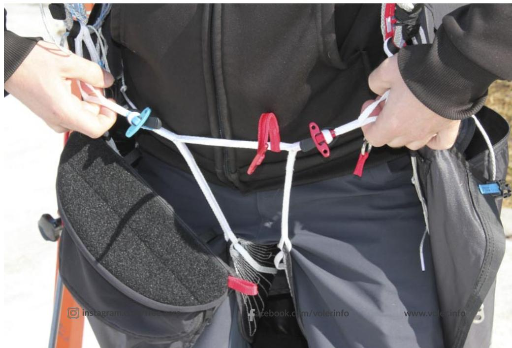
Un système de réglage de plus en plus utilisé en marche & vol et démocratisé notamment par Kortel : des épissures qui bloquent le réglage choisi sous tension.
