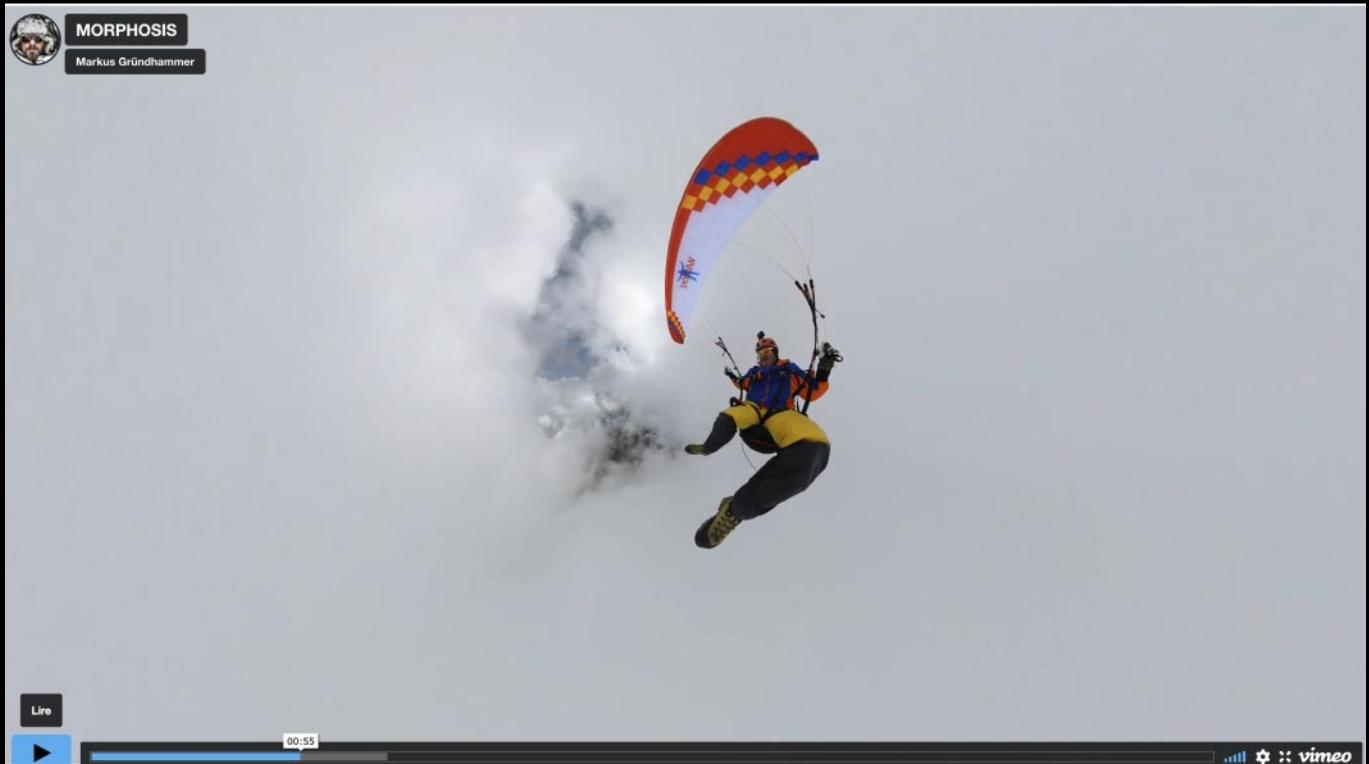
La photo de couverture provient d'une vidéo où Markus Gründhammer der Skyman titille les nuages en juillet 2022 : un voyage psychédélique. Il s'agit d'un prototype avec 26,5 m2 de surface et un allongement de 6. Le décrochage serait particulièrement sain avec une faible tendance au shoot.
