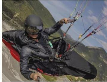
Une sellette très confortable, avec une formidable efficacité en roulis. L'assise est de style "hybride hamac", avec des renforts rigides importants placés sous les fesses et les cuisses.
