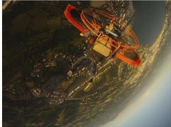
Ici on note bien la manière d'aborder le PowerLoop : passage à la verticale du logo "GTR", et non pas milieu de l'aile. Au moment où la photo est prise, il n'y a plus aucun mouvement de roulis, seulement du tangage. Ainsi, le looping se fait sur un plan incliné
