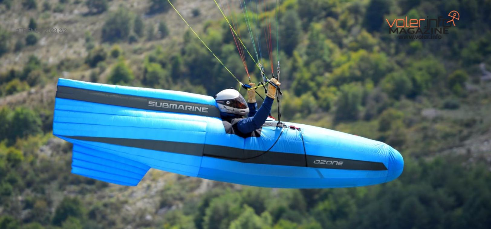
Le carénage est extrême sur le sous-marin, dont tout l'intérieur est en légère surpression barométrique. La fermeture presque hermétique du cocon pose deux nouveaux problèmes: les instruments ne sont pas très facilement accessibles, et la précision des mesures barométriques peut souffrir pour les petits changements (vario instantané pour systèmes intégrant les valeurs dans des algorithmes complexes ensemble avec gyromètre, accéléromètre)
